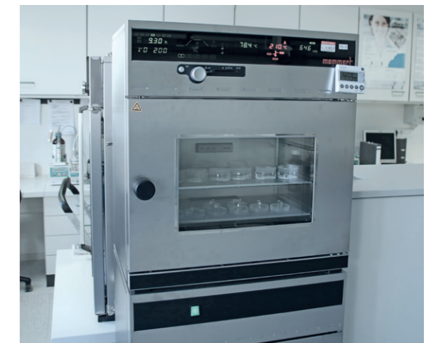
Vakuum-Trockenschrank zur Bestimmung des Trocknungsverlustes
